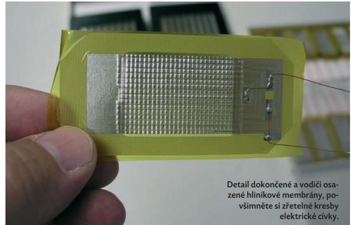
Detail dokončené a vodiči osazené hliníkové membrány, povšimněte si zřetelné kresby elektrické cívky.
