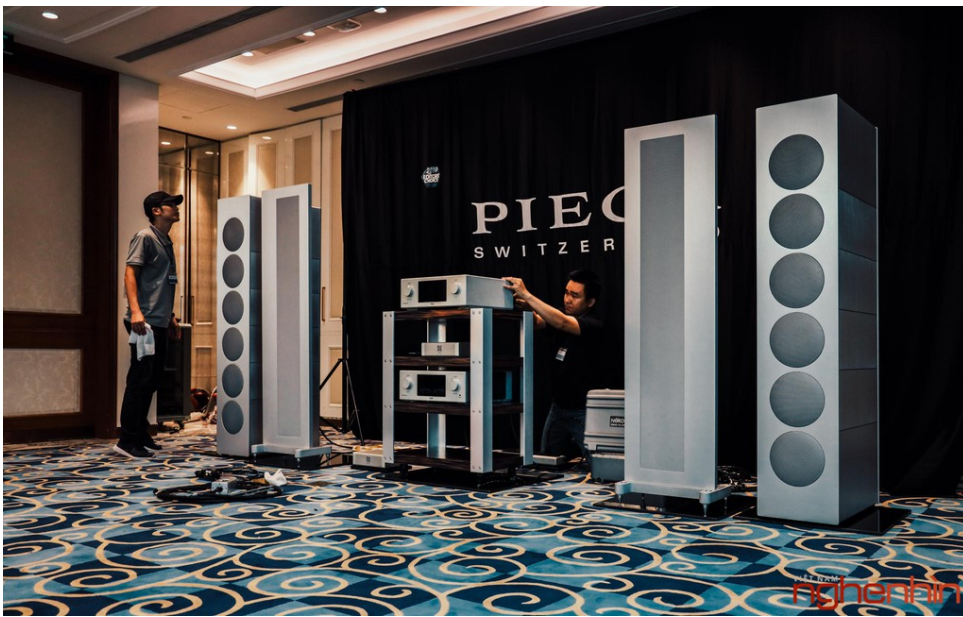
Piega Master Line Source sở hữu đến 4 tháp loa bao gồm 2 tháp chính chứa tổng cộng 33 driver ribbon và 2 tháp loa bass với 6 driver woofer.
