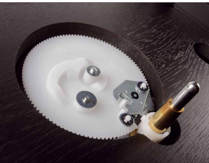
Klassische Dual-Zahnradmechanik und die gehärtete Stahlachse in ihrer Messingbuchse: solide Analogtechnik
