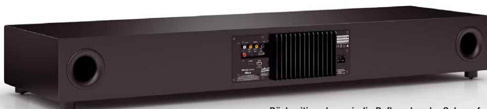
Rückseitig sehen wir die Reflexrohre der Subwoofer, das Anschlussfeld und die Kühlrippen der kräftigen Verstärkereinheit, mit der die Chassis einzeln angesteuert werden
