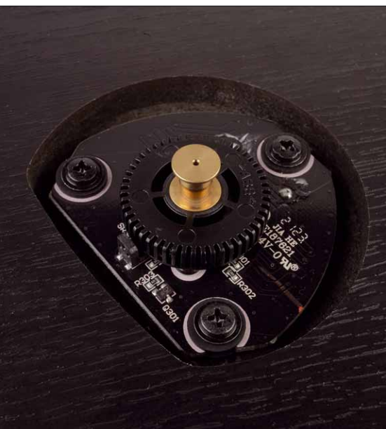
Hier wartet das Motorpulley aus Messing auf seinen Riemen. Das Material garantiert gute Laufflächen- und Ruhe. Darunter arbeitet der DC-Motor
