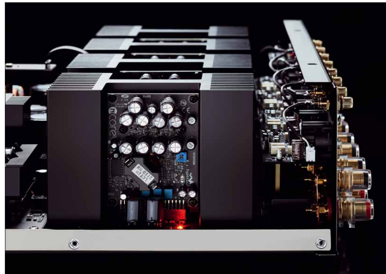
Die Endstufen sind paarweise auf einem H-förmigen Kühlkörper montiert
