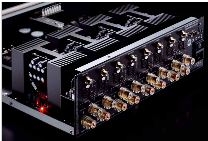
Die Endstufe kann wahlweise per XLR oder Cinch angesteuert werden
