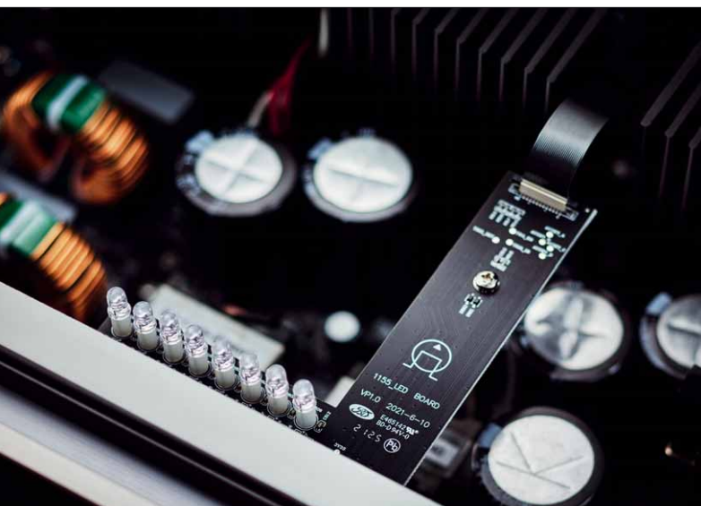
8 LED zeigen den Betriebszustand der Verstärkermodule an
