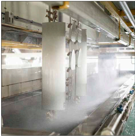
Die Eloxierung in den acht Sonderfarben ist logistisch und technisch eine Herausforderung.
