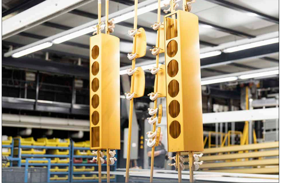
Hier kommen die frisch aus dem Tauchbad geholten Gehäuse ans Tageslicht. Mit den cleveren Halterungen zum Trocknen werden sie in der beheizten Halle aufgehängt.
